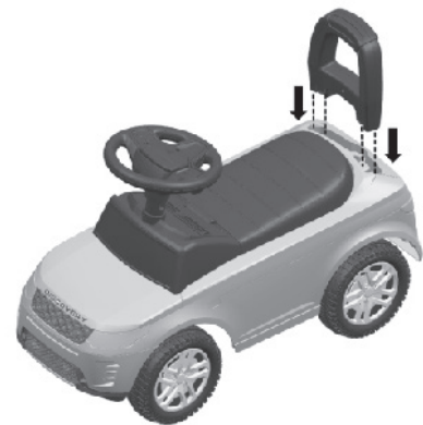
4. Monter ryglænet bagpå karrosseriet, og sørg for, at ryglænet er helt på plads.
