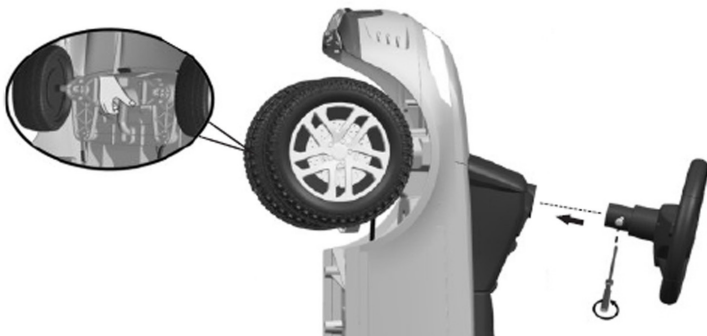
3. Hold ratakslen i bunden og placer derefter rattet over ratakslen, indsæt bolten og stram møtrikken med en skruetrækker (ikke inkluderet).
