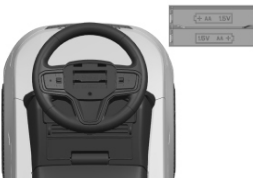
3. Hold ratakslen i bunden og placer derefter rattet over ratakslen, indsæt bolten og stram møtrikken med en skruetrækker (ikke inkluderet).
