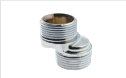
EXCENTERKOPPLING 160c/c --> 150c/c, M26x1,5 X G¾.
