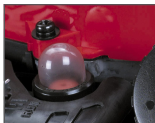
BRÄNSLEPUMP Bränslepump designad för lättare start.
