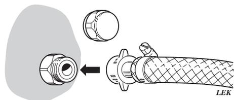
3. Avlägsna huven på avtappningsdonet (43) och anslut den medlevererade 1/2" slangkopplingen (44). Först när slangkopplingen anslutits till avtappningen öppnas automatiskt varmvattenberedarens inbyggda avtappningsventil.
