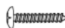
R.f. skruv 19x4,2 För montagefästning av skarvlist till takstol och infästning av ändlock
