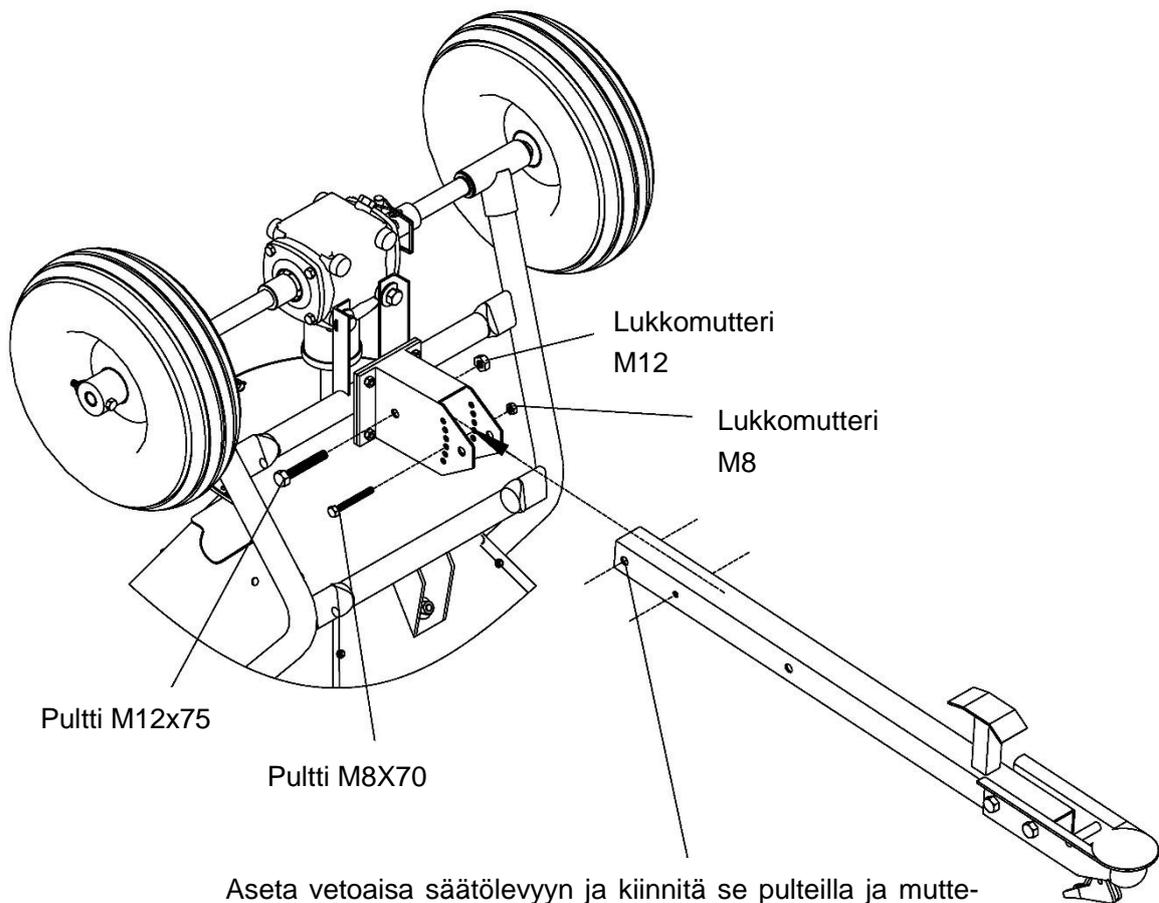
Aseta vetoaisa säätölevyyn ja kiinnitä se pulteilla ja muttereilla. Kiristä pultit.
