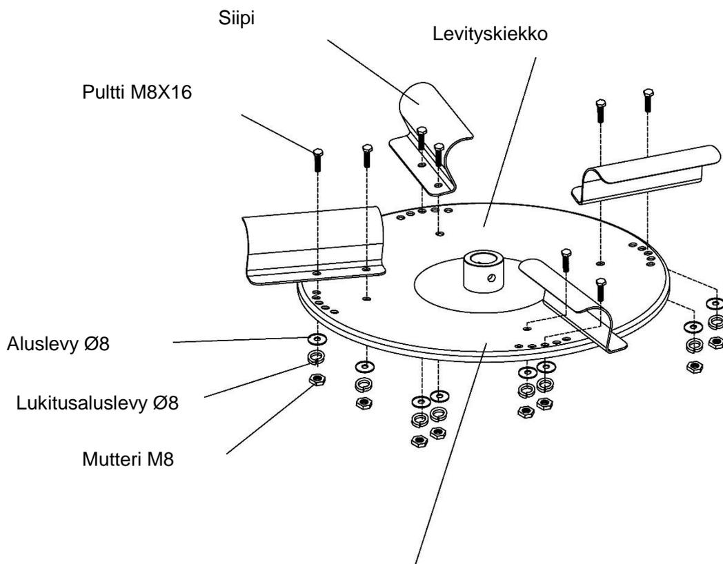
Kiinnitä siivet levityskiekkoon pulteilla, aluslevyillä ja muttereilla kuvan mukaisesti.
