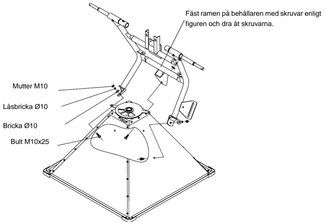
Vid montering ska behållaren läggas på sidan så att markeringen på behållaren pekar mot marken.
