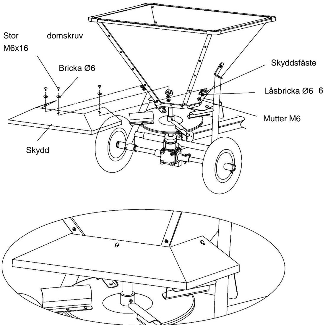
Dra åt alla skruvar och eventuella tidigare monterade skruvar som ännu inte dragits åt.
