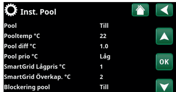
Meny "Avancerat/Inställningar/Pool". Pooltemperaturen höjs med 1 °C när funktionen "SmartGrid Lågpris" aktiveras.
