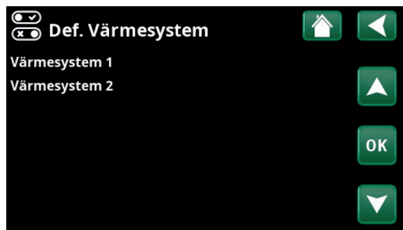
Meny "Avancerat/Definiera/Värmesystem". Markera ett värmesystem och tryck "OK" för att göra inställningar.
