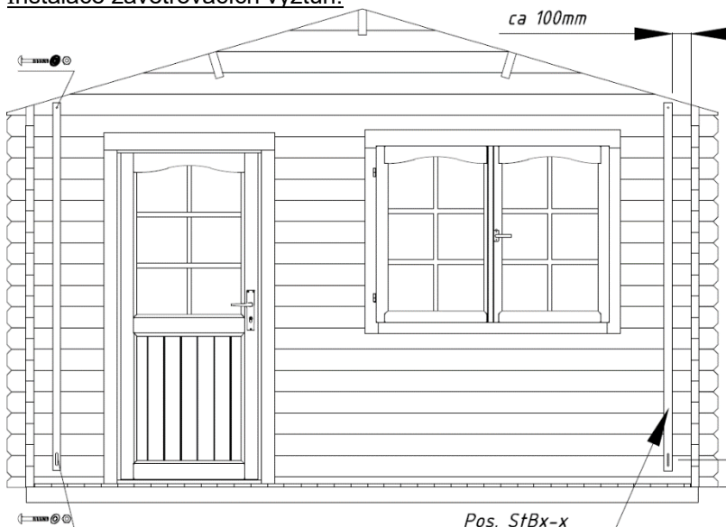
Instalace zavětrovacích výztuh:
