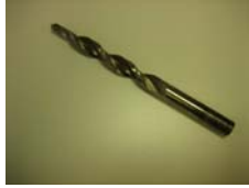
Borr \varnothing 5 mm och försänkare 10 mm
