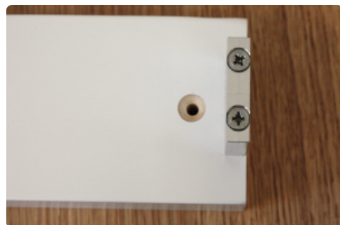
Nederkant borras likadant 15 mm från ovkant brickan.
