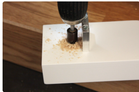
Försänk så att skruven inte kan ta i överliggaren.
