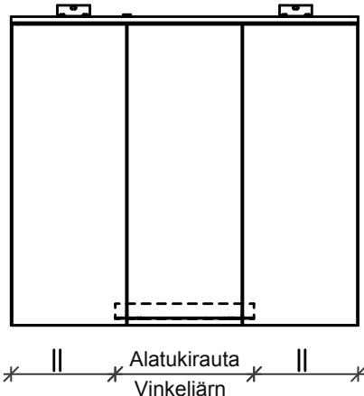
Nosta kaluste alatukiraudan päälle ja kiinnitä seinään sopivilla kiinnikkeillä yläpinnan kulmaraudoista (kiinnikkeet eivät kuulu toimitukseen). Lopuksi ruuvaa 4,5x15 ruuvit kalusteen alapintaan.
