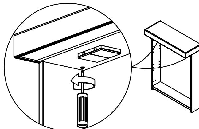
Löysää kiinnitysruuvit (2 kpl) peilikaapin sisältä.
