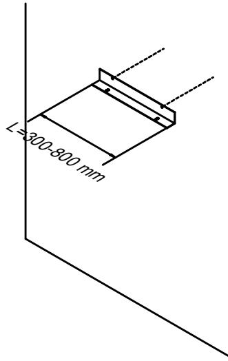
Aloita asennus kiinnittämällä alatukirauta seinään sopivilla kiinnikkeillä (eivät kuulu toimitukseen).
