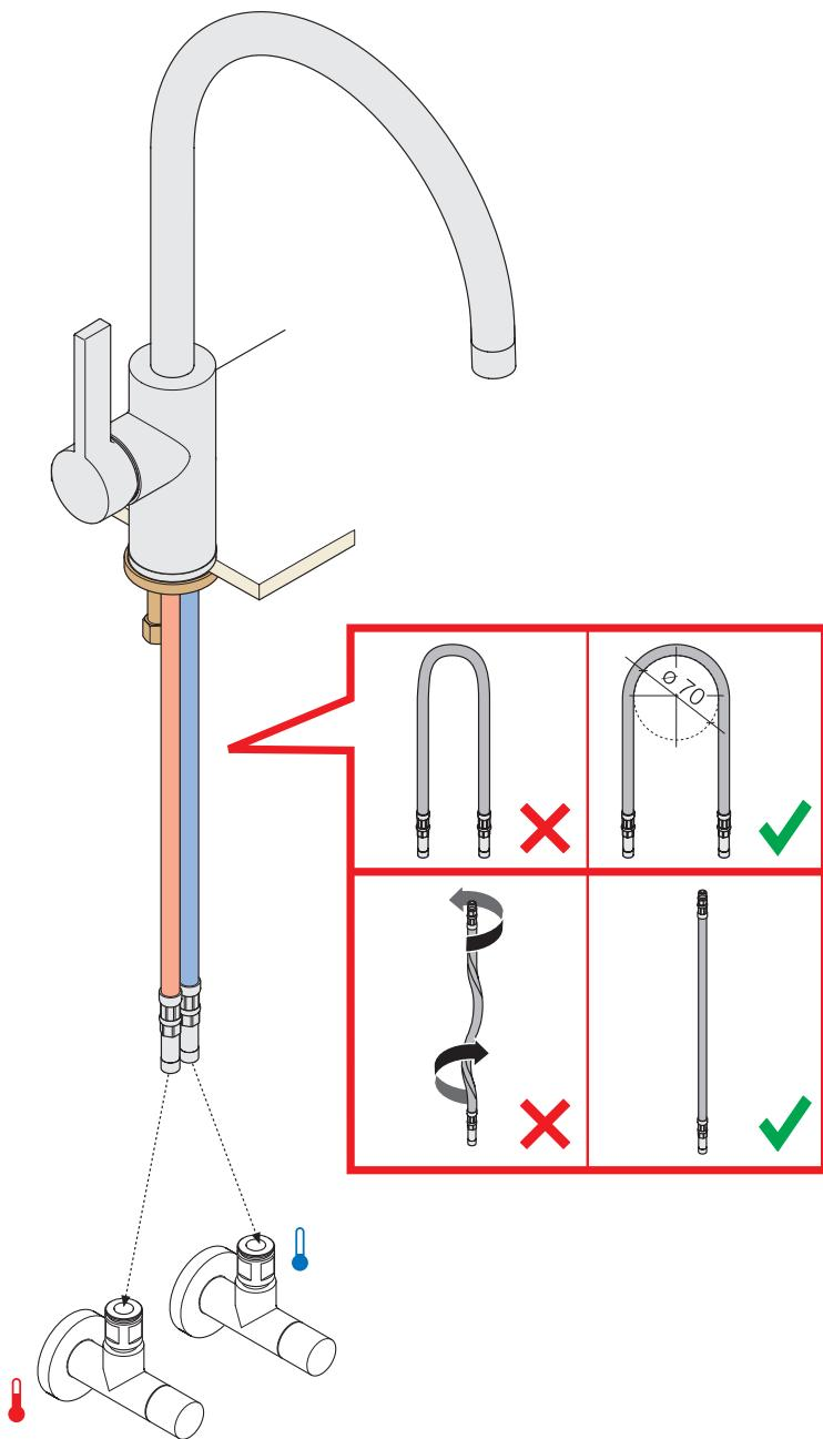
**Bei Montage Ø 35 mm //** 35 mm diameter for assembly // Bij montage diameter 35 mm // Pour diamètre de montage 35 mm // Con 35 mm diámetro de montaje // Al montaggio diametro 35 mm // 35 mm diameter for assembly // Vid montering diameter 35 mm // Při montáži průměr 35 mm // Przy montażu Ø 35 mm // При монтаже диаметр 35 мм // 安装直径为35 毫米
