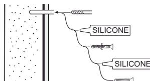
Skruvinfästningar i våtzon 1 ska göras i betong eller annan massiv konstruktion, träreglar, träkortlingar eller i konstruktion som är provad och godkänd för infästning, till exempel skivkonstruktion. Se exempel på godkända konstruktioner på [sakervatten.se](http://sakervatten.se).
