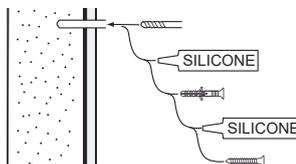
Skruvinfästningar i våtزون 1 ska göras i betong eller annan massiv konstruktion, träreglar, träkortlingar eller i konstruktion som är provad och godkänd för infästning, till exempel skivkonstruktion. Se exempel på godkända konstruktioner på säkervatten.se.
