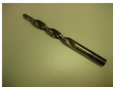
Borr \varnothing 5 mm och försänkare 10 mm
