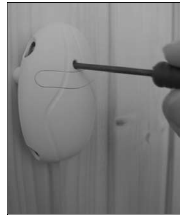
Kuva 11. Ylikuumenemissuojan palautuspainike Bild 11. Överhettningsskyddets återställningsknapp
