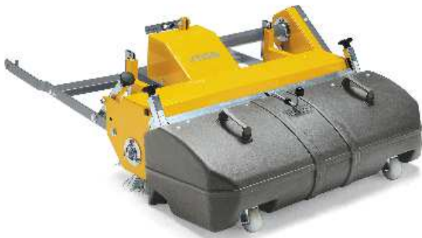
Sopaggregat med uppsamling. För borttagning av löv, grus, smuts och skräp från hårda ytor som asfalt eller betong. Lätt att tömma tack vare löstagbar behållare. Sidaborste finns som tillbehör.
