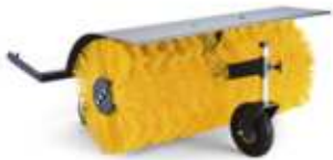
Sopaggregat (Park 740 IOX). Hydrauliskt kontrollerbart. Steglös justering i sidled. 95 cm arbetsbredd. Finns i fler utföranden anpassade för andra modeller av Stiga Park.
