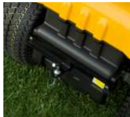
Maskinen är utrustad med dragkrok vilket gör att du har många användningsområden tack vare tillbehören som t. ex. roller, kombikärra, gödningsspredare.
