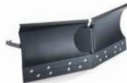
Vikplog hydraulisk (Park 740 IOX) Regleras hydrauliskt från förarsätet. Skrapskär i metall är standard.
